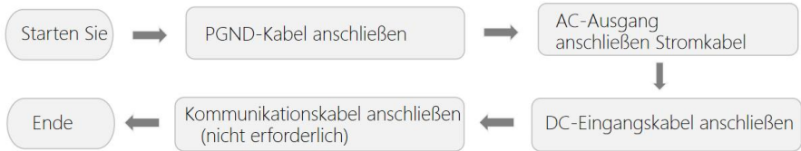
Abbildung 5-1: Flussdiagramm für den Anschluss der Kabel an den Wechselrichter.
